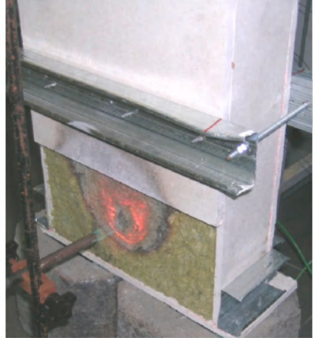
Fot. 2. Wełna mineralna – próbka przed (a) i w trakcie badania (b) Photo 2. Mineral wool (specimen before and during test)
