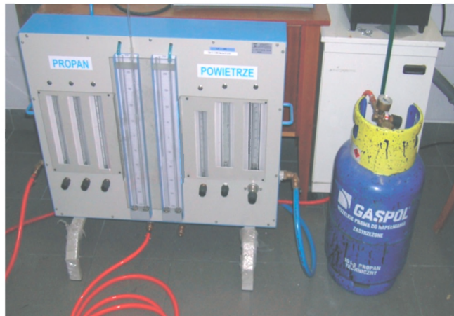
Fot. 1. Stanowisko pomiarowe do badań tlenia i żarzenia materiałów budowlanych (a) i układ zasilania palnika (b).
