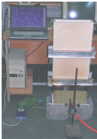
Fot. 1. Stanowisko pomiarowe do badań tlenia i żarzenia materiałów budowlanych (a) i układ zasilania palnika (b).
