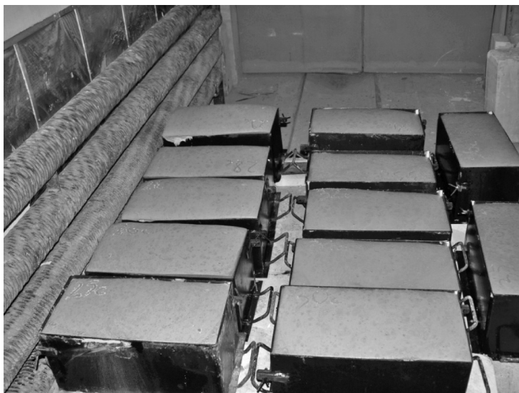
Ryc. 3. Odlewy betonu komórkowego wg pierwszego wariantu recepturowego dojrzewające w komorze
