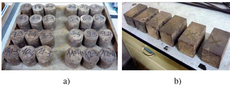
Źródło: Opracowanie własne. Ryc. 1. Próbkę do badania odporności na wstrząsy cieplne: a) walce \varnothing = h = 50 mm, b) prostopadłościowy 64 mm x 64 mm x 114 mm
