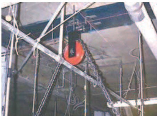
Rys. 4. Układ z cięgnami jako obciążenie próbne [2]
