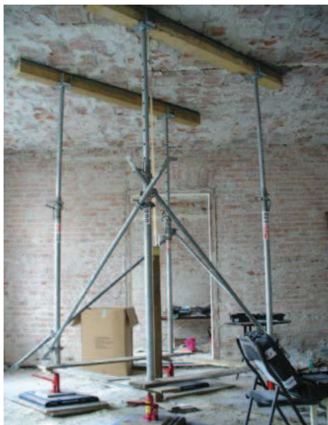
Rys. 3. Obciążenia z wykorzystaniem siłowników i elementów rusztowaniowych [4]
