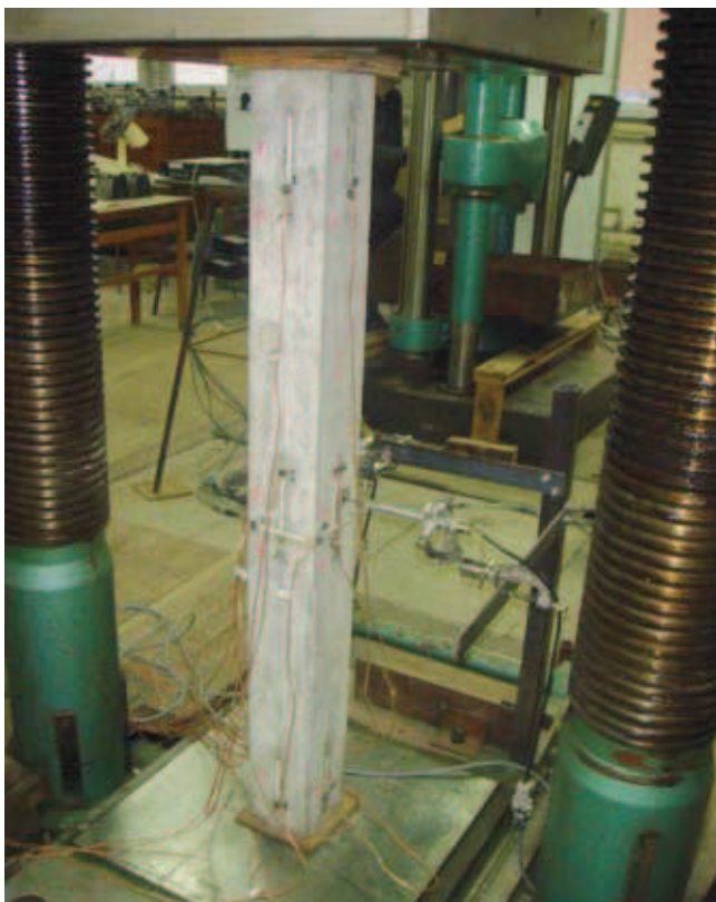
Rys. 2. Model słupa żelbetowego podczas badań w prasie hydraulicznej
