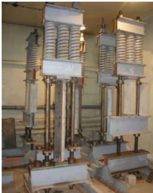
Rys. 3. Modele słupów podczas badań pod obciążeniem długotrwałym
