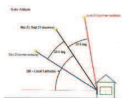
Rys. 6. Schemat wysokości słońca dla różnych pór roku 8
