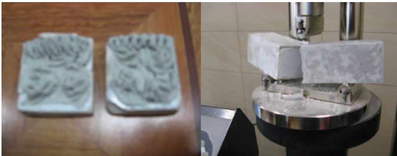
Rys. 3. Próbkę stłuczki ceramicznej do badań przyczepności z nałożoną warstwą szepną i beleczka zawierająca próbkę stłuczki po badaniu przyczepności do zaczynu
