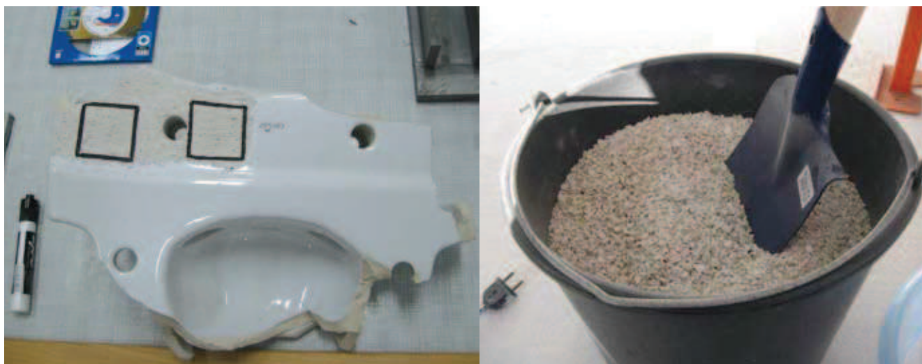
Rys. 1. Stłuczka sanitarna (fragment uszkodzonej umywalki) z oznaczonymi miejscami poboru próbek do badań przyczepności oraz uzyskane z niej kruszywo frakcji 4÷8 mm
