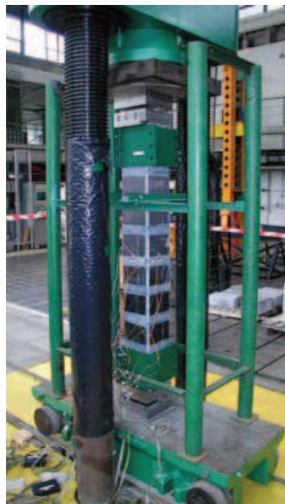
Rys. 1. Słupy żelbetowe wzmocnione taśmami i matami CFRP – opaski i ciągły płaszcz
