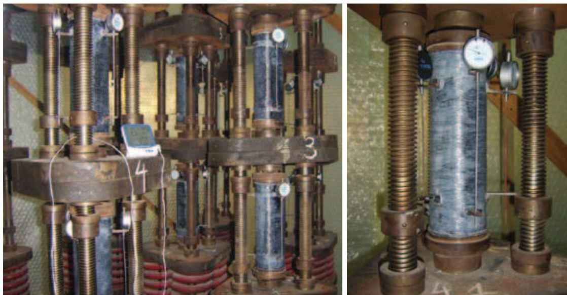
Rys. 2. Badania reologiczne próbek wzmocnionych materiałami CFRP
