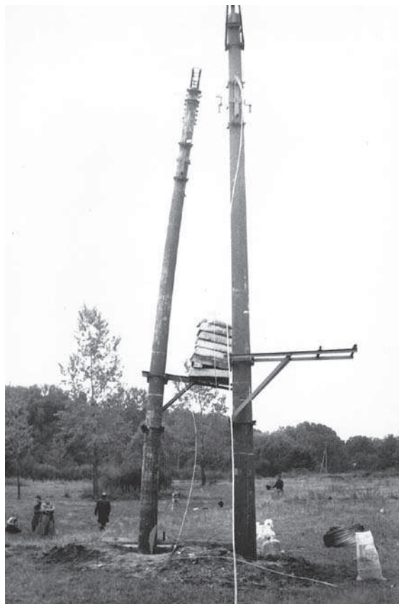
Rys. 1. Badania poligonowe strunobetonowych żerdzi wirowanych E12/10
