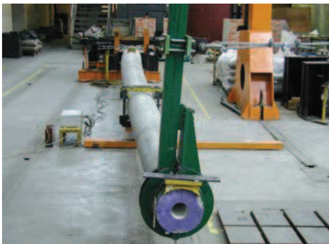
Rys. 3. Urządzenie do zaczeplenia siły P w celu realizacji badania żerdzi na skręcanie ze zginaniem
