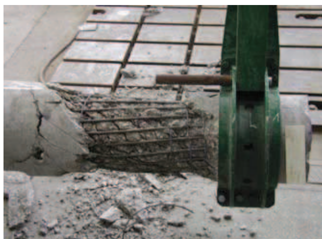
Rys. 6. Zbliżenie na miejsce zniszczenia żerdzi E na skręcanie
