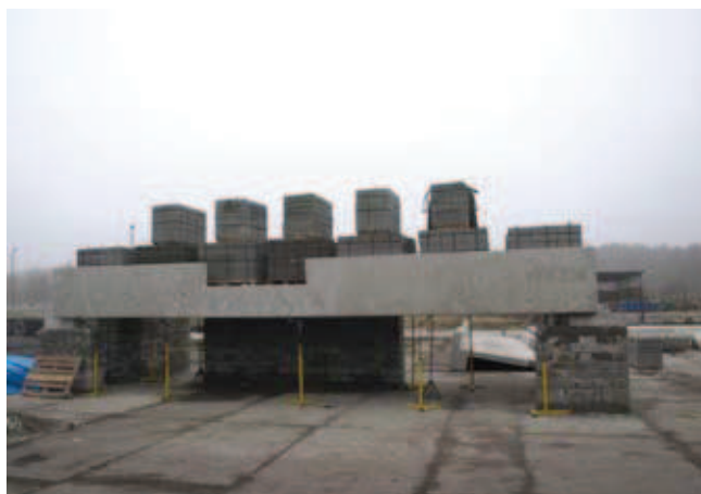
Rys. 6. Płyta obciążona układem dziewiętnastu palet (wartość maksymalna obciążenia q_k = 8,97 kPa)
