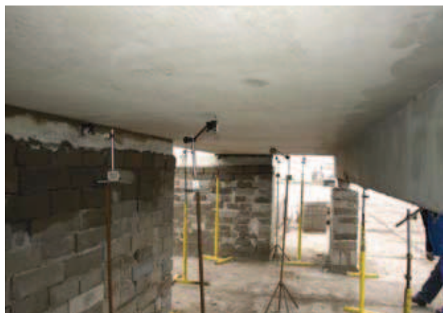
Rys. 7. Rozmieszczenie czujników zegarowych do pomiaru ugięcia płyty
