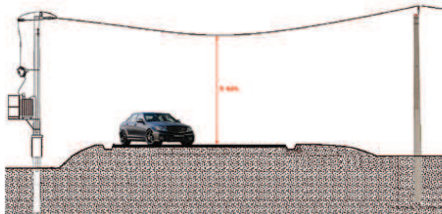
Rys. 8. Przykładowy profil skrzyżowania linii napowietrznej z drogą asfaltową
