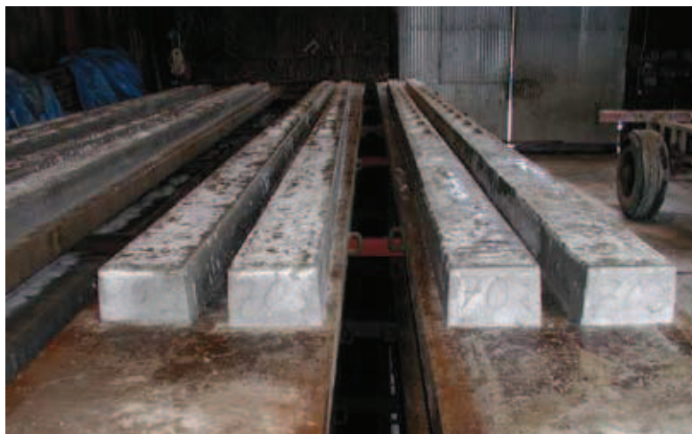
Rys. 2. Żerdzie ŻN/200 ułożone parami na blatach w komorze obróbki termicznej betonu
