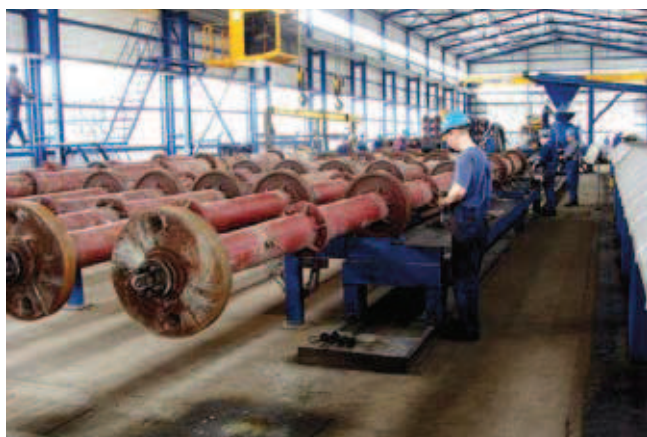
Rys. 10. Formy na trasie pochylej w hali nr 3 (druga linia produkcyjna żerdzi typu E i oświetleniowych typu EOP)
