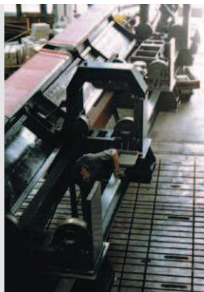
Rys. 3. Wirówka rolkowa produkcji czechosłowackiej zmontowana w Laboratorium Instytutu Budownictwa Politechniki Wrocławskiej dla PBE Elbud Gdańsk (czerwiec 1996 r.)
