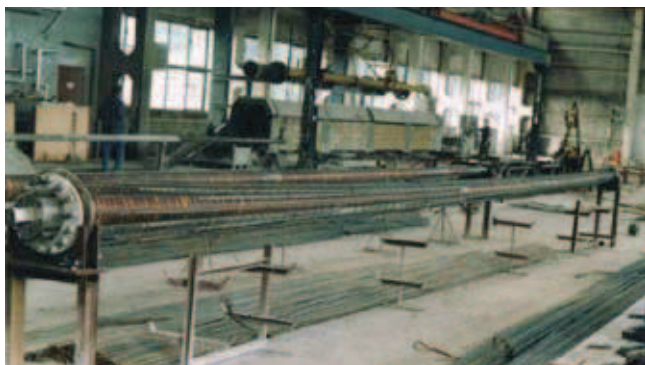
Rys. 4. Wyposażenie oddziału produkcji żerdzi wirowanych w WPZ Owśnice (24.06.1998 r.). Na pierwszym planie kosz zbrojeniowy żerdzi E12/12, w głębi wirówka i przesuw- nica pomostowa
