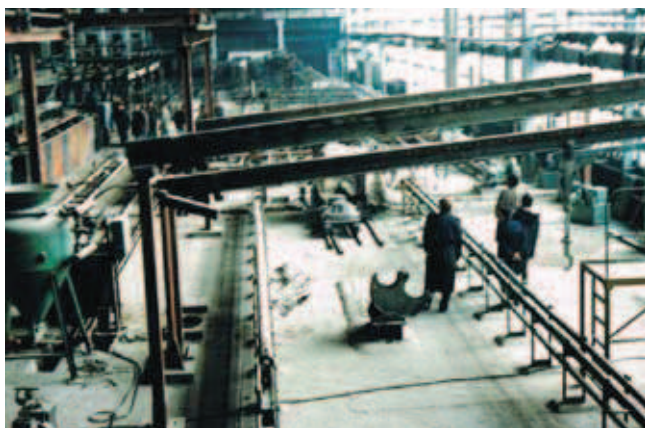
Rys. 1. Częściowo zmontowane urządzenia do produkcji żerdzi wirowanych w Ostrowie Wielkopolskim (1992 r.)
