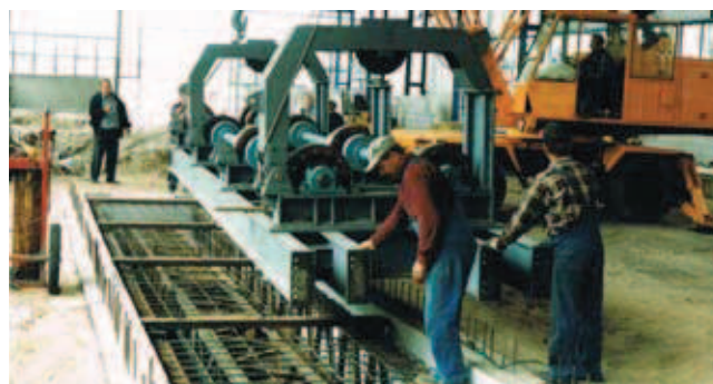
Rys. 7. Montaż jednej z trzech części wirówki o długości 27 m w nowej hali do produkcji żerdzi wirowanych w Kuzkach koło Włoszczowej
