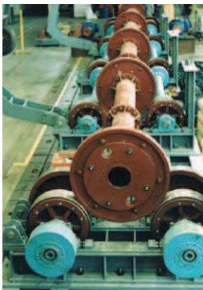
Rys. 6. Wirówka rolkowa z napędem na koła toczne połączone wałem Cardana wykonana w Laboratorium Instytutu Budownictwa Politechniki Wrocławskiej (1991 r.)
