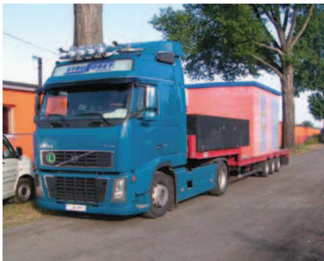
Rys. 4. Transport kontenerowej stacji transformatorowej KSW samochodem z naczepą niskopodwoziową
