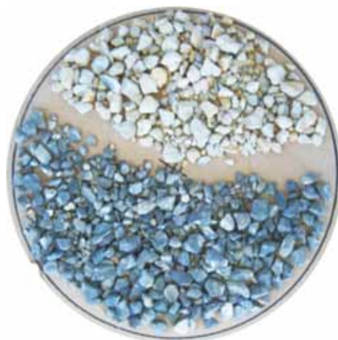
Fot. 1. Układ materiału dewon/trias w kruszywie dolomitowym (60/40)
