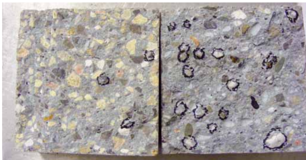
Fot. 2. Przełamy próbki po badaniu wytrzymałości na rozciąganie przy rozłupywaniu na kruszywie dolomitowym (lewa strona) i żwirowym (prawa strona).
