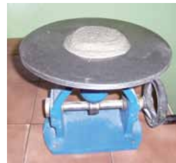
Badanie metodą stolika rozptyłu na zaprawach normowych
