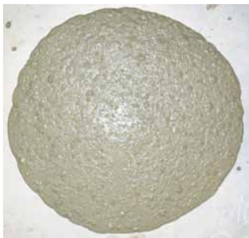
Rys. 3. Przykład mieszanki stabilnej VSI 0 i bardzo niestabilnej VSI 3
