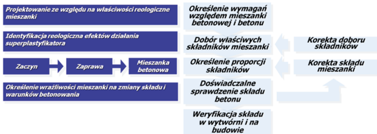
Rys. 1. Algorytm projektowania betonu samozagęszczalnego
