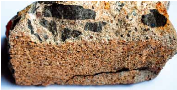
Fot. 7. Próbką betonu z elewacji sprzed renowacji z widoczną warstwą ochronną (fot. autora)
