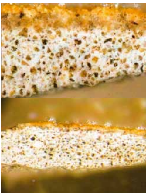
Fot. 8. Przekrój przez zaprawę wapienną (stratygrafia próbki), widoczny roztwór szkła wodnego i jasnoogrowa warstwa malarska – oprac. Ryszard Wójtowicz [4]
