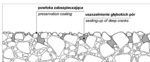
4. Stan projektowany - struktura betonu uszczelniona w niezbędnym zakresie. Further condition designed - the concrete structure sealed where necessary
