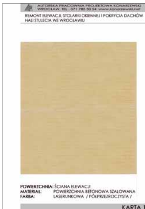
Rys. 3. Renowacja powierzchni elewacji betonowej - próbka kolorystyczna, oprac. APP-Konarzewski
