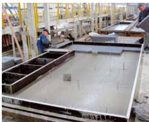
Rys. 4. Układanie warstwy styropianu, źródło K. Chęcińska scc firmy: Halfen i Jordahl&Pfeifer). W katalogach producenta znajdujemy tabele wymiarowania kotew, w których – wychodząc od siły działającej na warstwy, geometrii elementu – dobiera się typ i wielkość kotew oraz ich rozmieszczenie w elemencie. Pomocne są programy pomiarowe, dostępne do ściągnięcia na stronach internetowych producentów. Generalnie, przy doborze i wymiarowaniu kotew w elemencie pod uwagę bierze się następujące czynniki:
