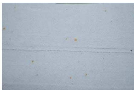
b) klej cementowy z dodatkiem reduktora o granulacji 0,2-1,0 mm
