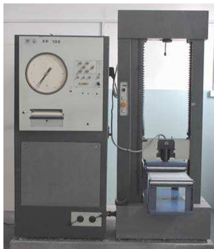
Ryc. 3. Stanowisko do badania wytrzymałości szkła na zginanie czteropunktowe
