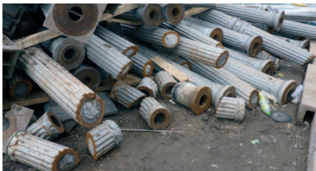
Fot. 10. Składowisko „zdemontowanych” (zniszczonych) słupów Hartunga we Wrocławiu
