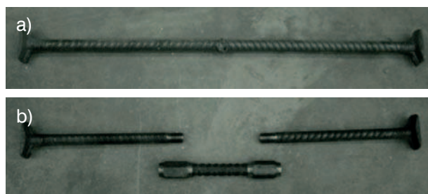
Rys. 1. Trzpienie stosowane we wspornikach dobetonowanych do słupów: a) trzpień ciągły, b) trzpień trzyczęściowy
