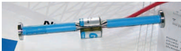
Rys. 5. Czujnik strunowy o bazie 153 mm
