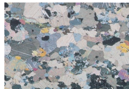
Fot. 6. Marmur o strukturze granoblastycznej charakteryzującej się obecnością izometrycznych blastów kalcytu. Obraz mikroskopowy
