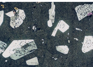
Fot. 4. Porfir o dużych kryształach skaleni, tkwiących w cieście skalnym (struktura porfirowa). Obraz mikroskopowy
