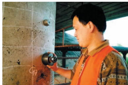
Fot. 4. Widok pierścienia do-diskowego zapewniającego równomierny rozkład naprężeń w czasie pomiaru
