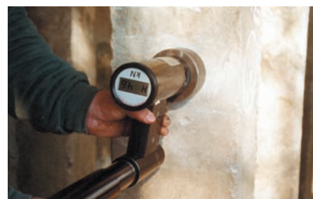
Fot. 3. Urządzenie o nazwie BOND-Test
