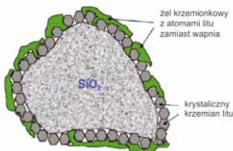
Rys. 12. Warstwa ochronna wokół ziarna krzemionki tworzona przez produkty reakcji \text{SiO}_2 z \text{LiNO}_3 w zaczynie cementowym wg X. Fenga i wsp.
