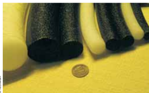
Rys. 4. Przykłady kordów wypełniających szczeliny w nawierzchni betonowej
