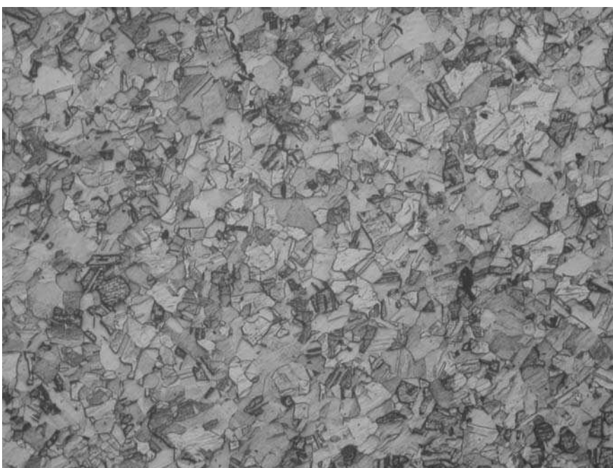
Ryc. 5. Mikrostruktura taśmy z mosiądzu M70 wyżarzonej w dolnej strefie starego pieca kołpakowego
