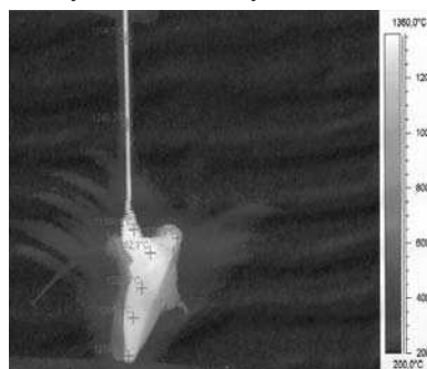
Ryc. 8. Obraz termograficzny strugi stopionego szkła
