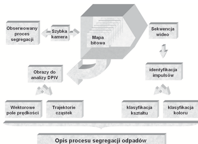
Ryc. 2. Przykładowa metodyka prowadzenia badań segregacji aerodynamicznej odpadów z wykorzystaniem optycznych metod pomiarowych
