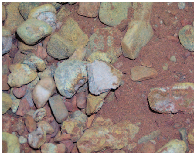
Rys. 5, 6. Kruszywo otrzymane po ekstrakcji z próbek betonów, pobrane z ocenianych stropów
