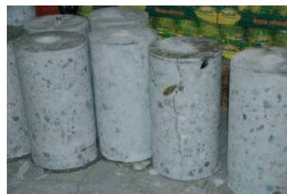
Rys. 6. Odwierty rdzeniowe płyty zbiornika. Próbki przygotowane do badań w maszynie wytrzymałościowej [9]
