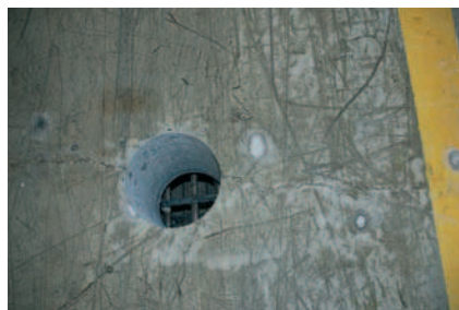
Rys. 6. Odwierty rdzeniowe płyty zbiornika. Próbki przygotowane do badań w maszynie wytrzymałościowej [9]
