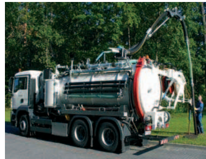
Rys. 13. Wóz do ciśnieniowego czyszczenia kanałów i kolektorów kanalizacyjnych [8]
