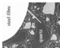
Rys. 7. Obraz stref stykowych między fazą C-S-H i włóknem oraz ziarnem kwarcowym w BPR dojrzewającym w wodzie (pow. 2000x) wraz z liniową analizą EDS (operator: mgr B. Trybalska)
