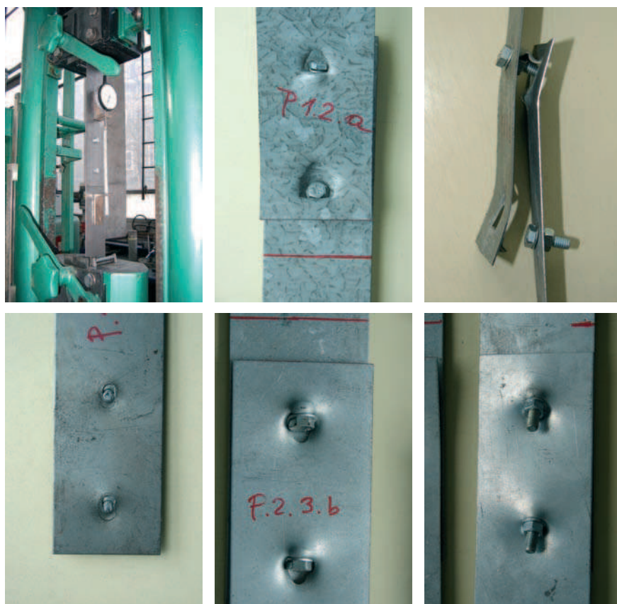
Rys. 8. Przykładowe postacie zniszczenia próbek i łączników; w górnym rzędzie od lewej: próbka w maszynie wytrzymałościowej, śruby M6/blacha 0,8 mm, M6/1 mm; w dolnym rzędzie od lewej: M6/1,5 mm, M8/1,5 mm od strony łbów, M8/1,5 od strony nakrętek
