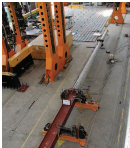
Rys. 10. Słup trakcyjny ETG na stanowisku badawczym do badań na zginanie
