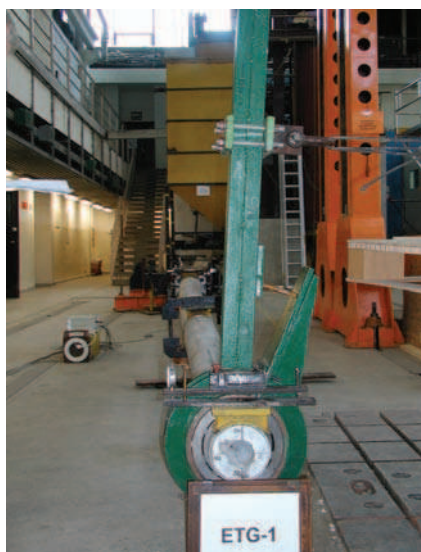
Rys. 12. Słup trakcyjny ETG-1 na stanowisku do badania skręcania ze zginaniem
