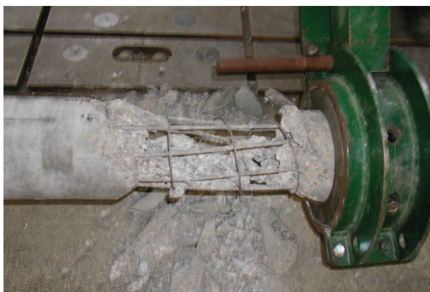
Rys. 13. Zniszczenie słupa ETG-1 podczas badania skręcania ze zginaniem
