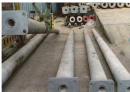
Rys. 5. Słupy ETG z głowicami stalowymi wykonane w Instytucie Budownictwa Politechniki Wrocławskiej (czerwiec – lipiec 1996 r.)
