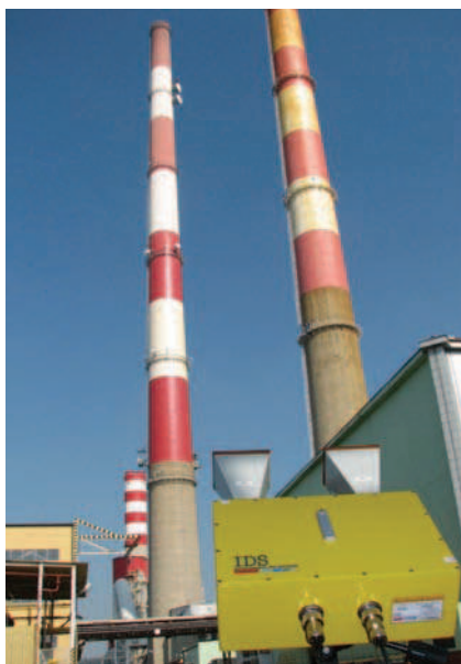
Rys. 2. Mikrofalowy radar interferometryczny podczas badań dynamicznych komina żelbetowego K1 H = 260 \text{ m}
