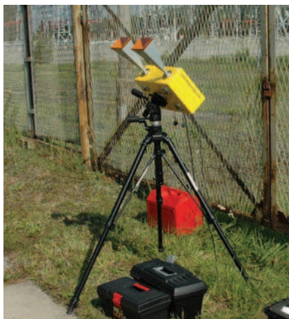
Rys. 1. Mikrofalowy radar interferometryczny w trakcie pomiarów
