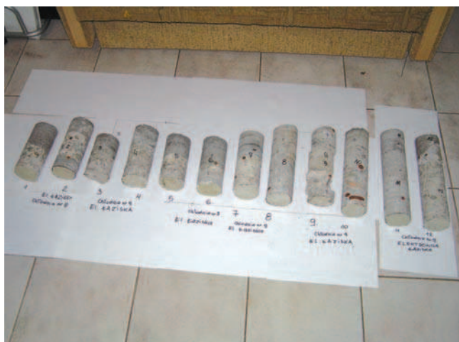
Rys. 6. Widok ogólny pobranych próbek z jednego z południków płaszczu chłodni
