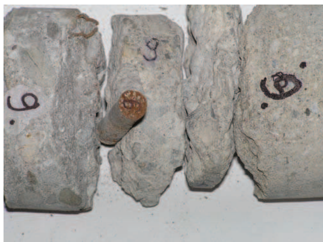
Rys. 7. Przykład rozwarstwionej próbki
