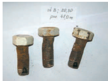
Fot. 2. Plastyczne deformacje śrub
