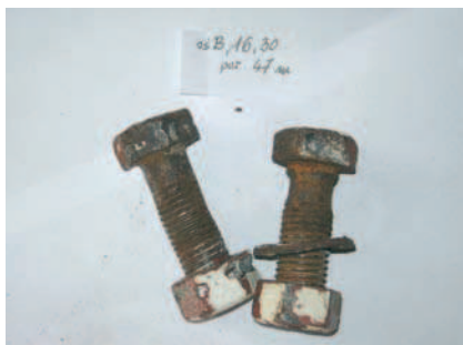
Fot. 1. Korozyjne zużycie śrub
