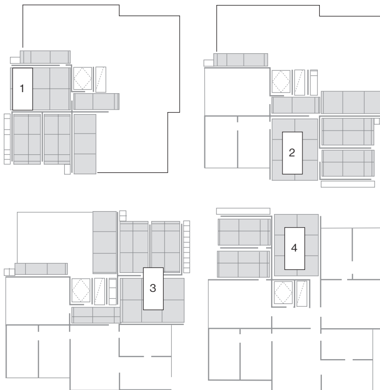
Rys. 1. Przemieszczenie kompletu urządzeń formujących zgodnie z zasadą taśmy produkcyjnej. Podział budynku na cztery działki robocze oznaczone cyframi od 1 do 4
