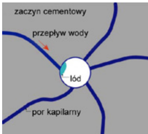
Rysunek 5. Schemat poru powietrznego przecinającego kapilary w stwardniałym zaczynie cementowym [9]
