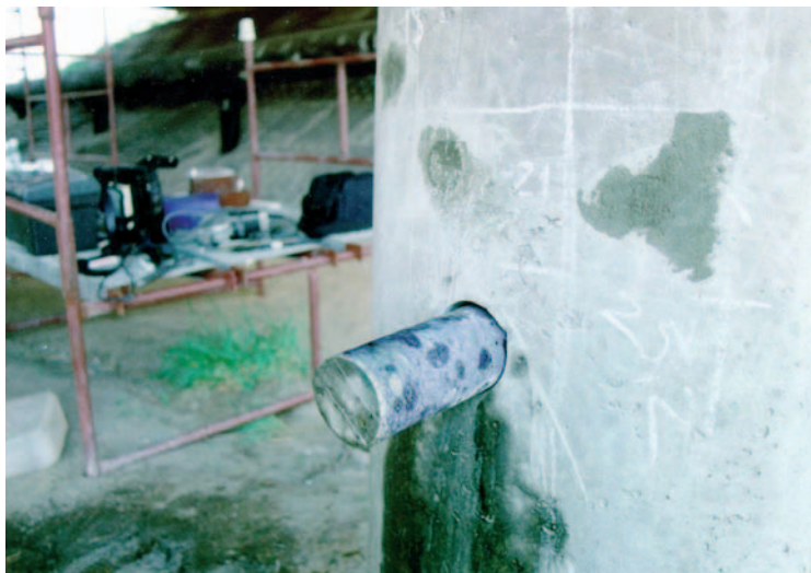
Fot. 6. „Rainbow-Test” wykonany na powierzchni odwiertu (kolor granatowy – pH 13)
