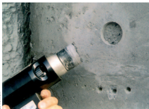
Fot. 5. Pomiar „pull-off” – widok prawidłowego przetłomu
