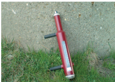
Fot. 3. Sklerometr Schmidta typu „M”
