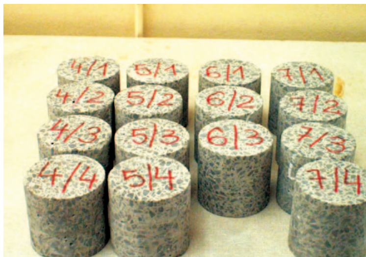
Rys. 1. Widok próbek przygotowanych do badań, których wynik ma się odnosić do wytrzymałości badanej na normowych próbkach sześciennych ( h=\varnothing=100\text{ mm} )
