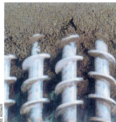
Rys. 6. Widok ślimaków zagęszczających mieszankę w procesie formowania płyt
