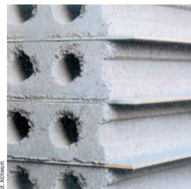
Rys. 8. Widok płyt w fazie dojrzewania betonu
