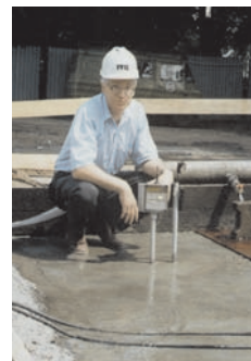
Sonda systemu SPT-GSM-GPS podczas monitorowania płyty stropowej tunelu Wisłostrody
