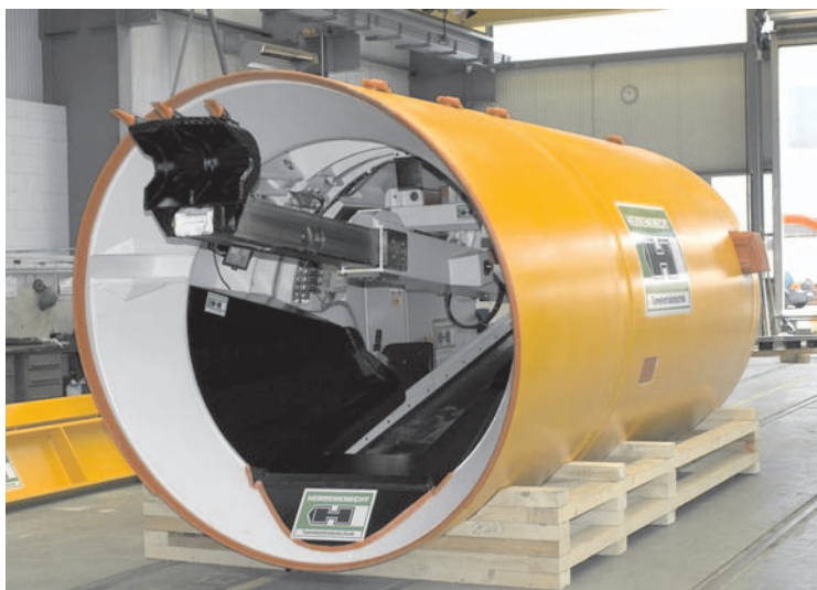
Fot. 1. Maszyna do mikrotunelowania z otwartą tarczą
