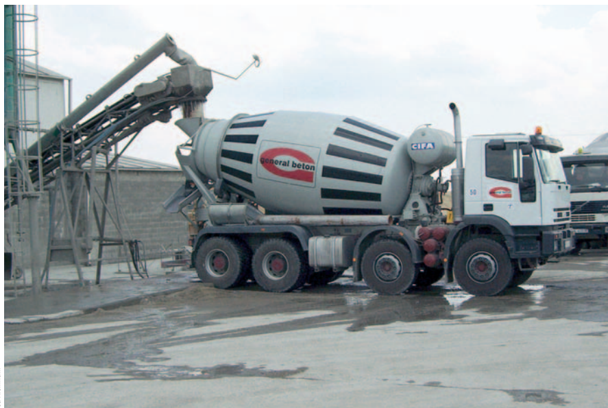
Fot. 1. Hydrauliczny układ przeniesienia napędu z silnika macierzystego ciężarówki
