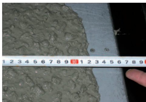
Rys 2. Badanie rozptywu betonowego placka metodą odwróconego stożka Abrahamsa
