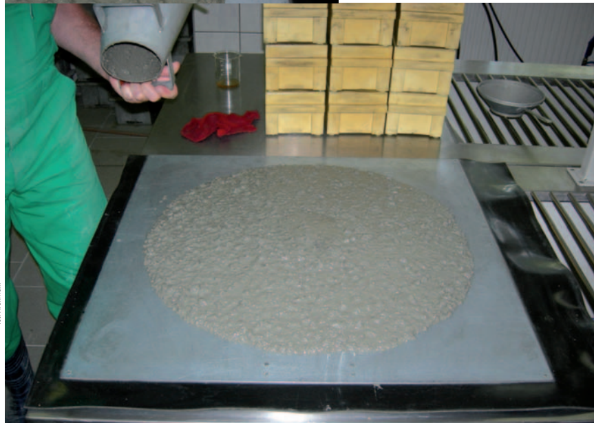
Rys 2. Badanie rozptywu betonowego placka metodą odwróconego stożka Abrahamsa
