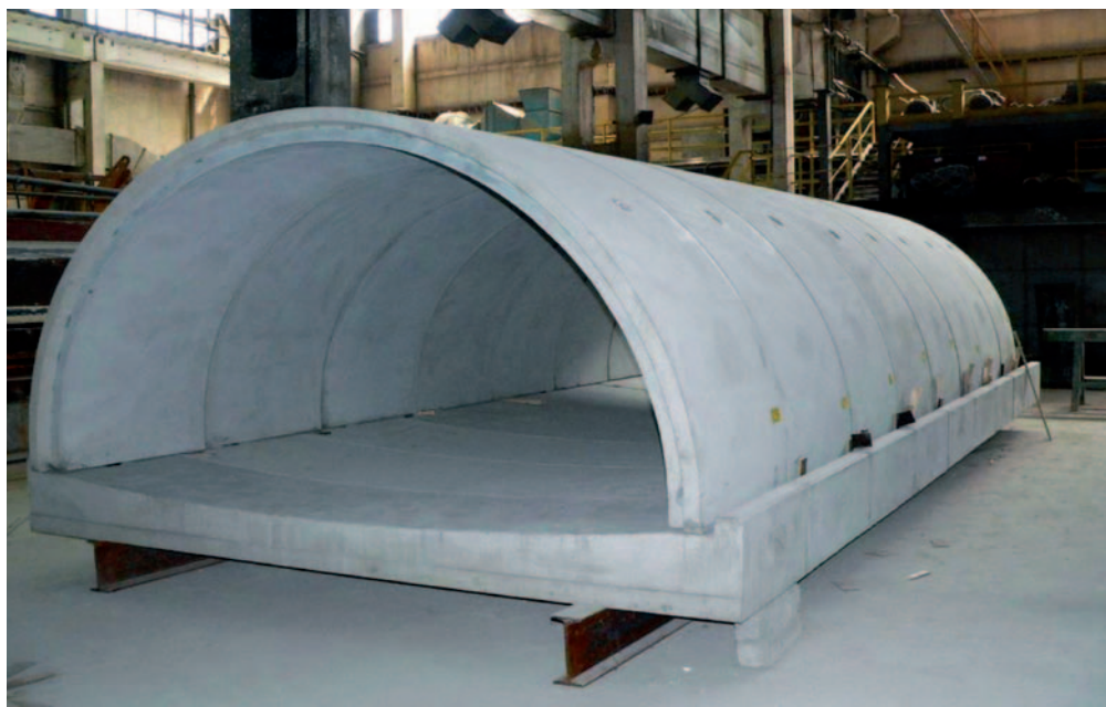
Próbną montaż kolektora w hali produkcyjnej
