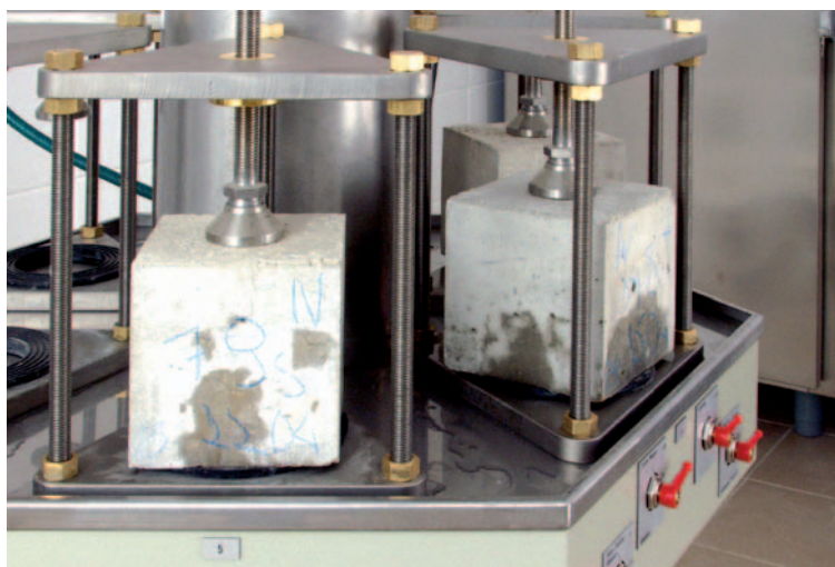
Stanowisko do badania wodoszczelności betonu
